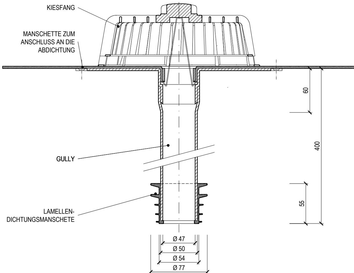
Name **EINWANDIGES SANIERUNGSGULLY FÜR DÄCHER OHNE WÄRMEDÄMMUNG**
