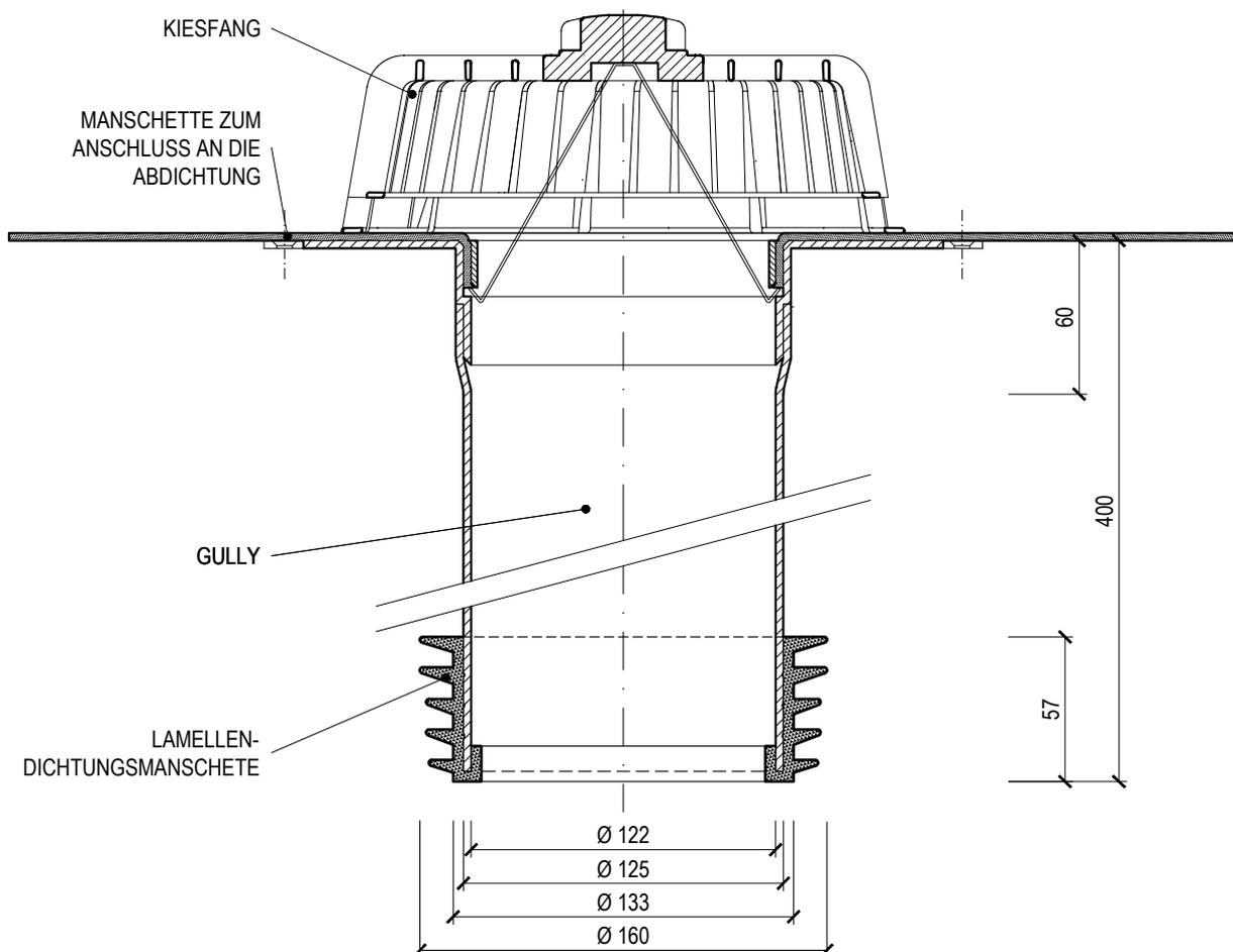
Name **EINWANDIGES SANIERUNGSGULLY FÜR DÄCHER OHNE WÄRMEDÄMMUNG**
