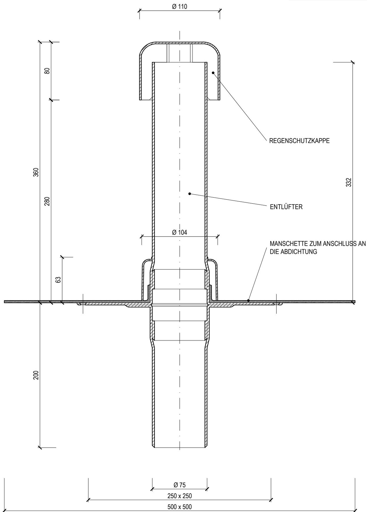
Name **ENTLÜFTUNG FÜR DEN ROHRLEITUNGSANSCHLUSS**
