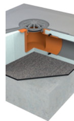
Dachaufbau mit begehbaren Abdichtung
