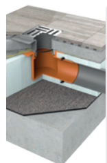
Dachaufbau mit geklebter Schicht
