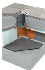
Dachaufbau mit Drainageschicht
